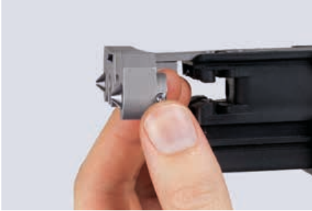
1. Splint mit Passstift nach oben ziehen
