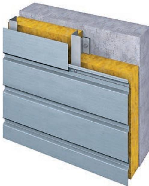
Zweiteilige metallene Unterkonstruktion
