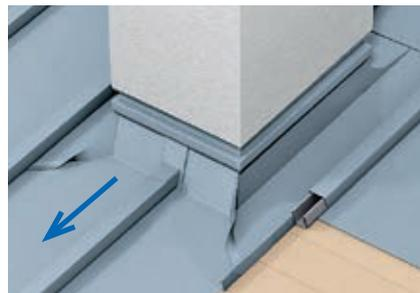
Skizze 65: Anschluss an Kamin im Brustbereich mit Firstaufstellung und Firstkappe sowie Kappleiste
