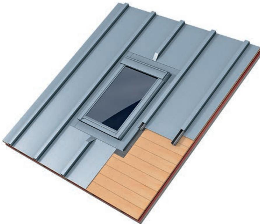
Skizze 70: Dachflächenfenster mit falztechnischer Einbindung
