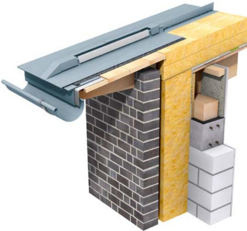
Skizze 19: Konstruktionsbeispiel mit Verlegung der Klick-Leistendeckung auf ROCKWOOL® Prodach-Dämmsystem
