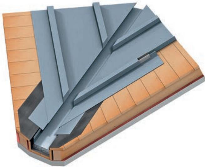
Skizze 55: Vertiefte Kehle; zulässige Dachneigungen  $\geq 3^\circ$  bis  $\leq 10^\circ$
